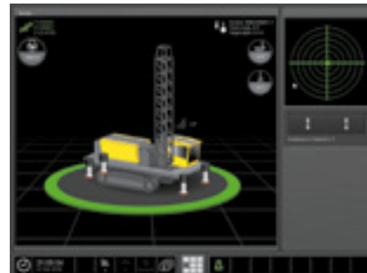
Настройка и ход: показывает состояние машины во время настройки и во время движения.
